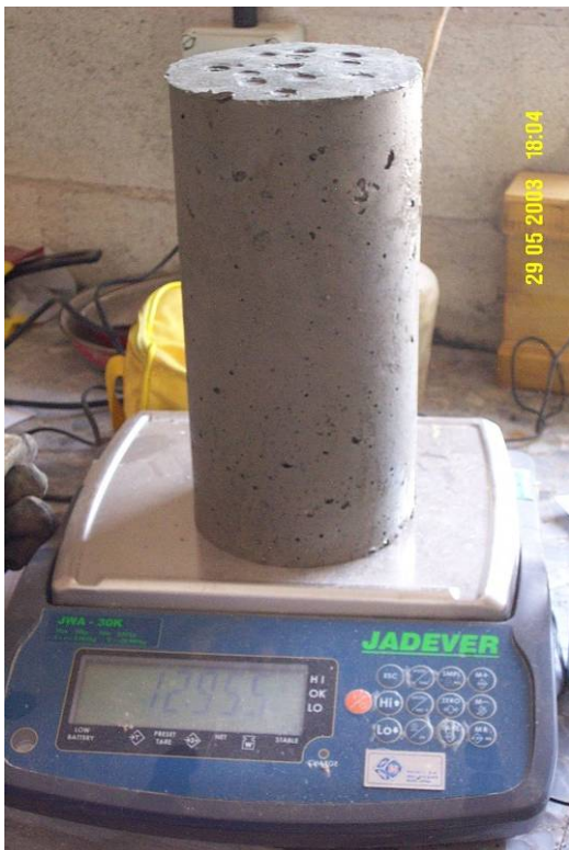
Foto 5. Probeta con huellas del esclerómetro en su cara superior.
