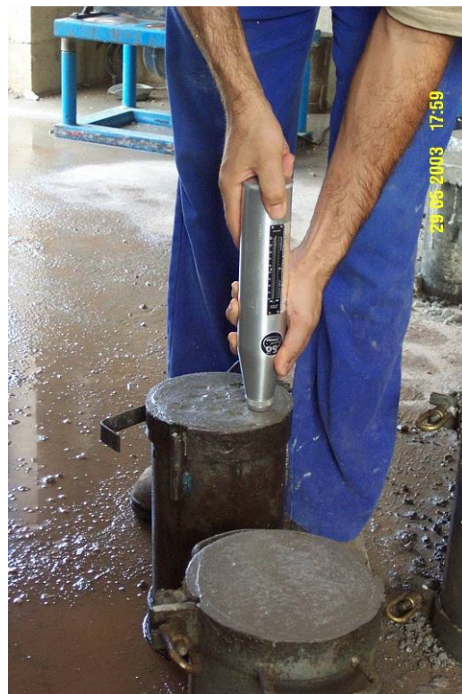
Foto 5. Probeta con huellas del esclerómetro en su cara superior.
