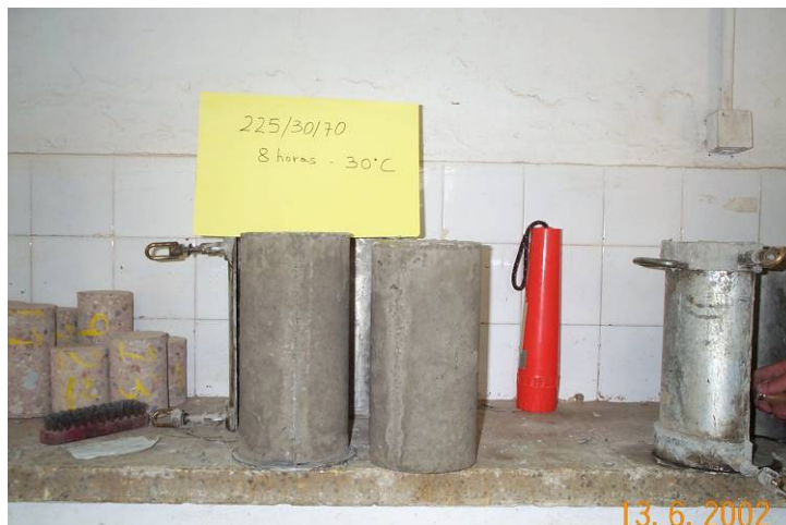
Foto 3. Probeta curada a 30 °C y desmoldada a 8 h. sin ninguna anomalía
