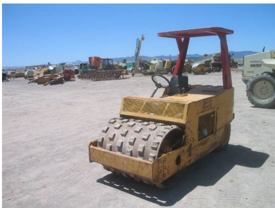
Foto 8 y 9. Dos modelos de compactadores "rugosos"
