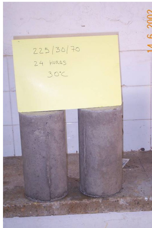
Foto 4. Probeta curada a 30 °C y desmoldada a 24 h
