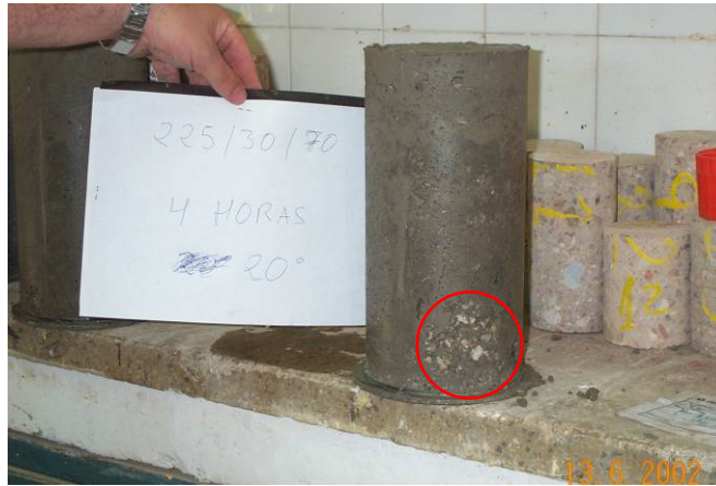
Foto 2. Probeta curada a 20 °C y desmoldada a 4 h. (obsérvese el ligero descascarillado)
