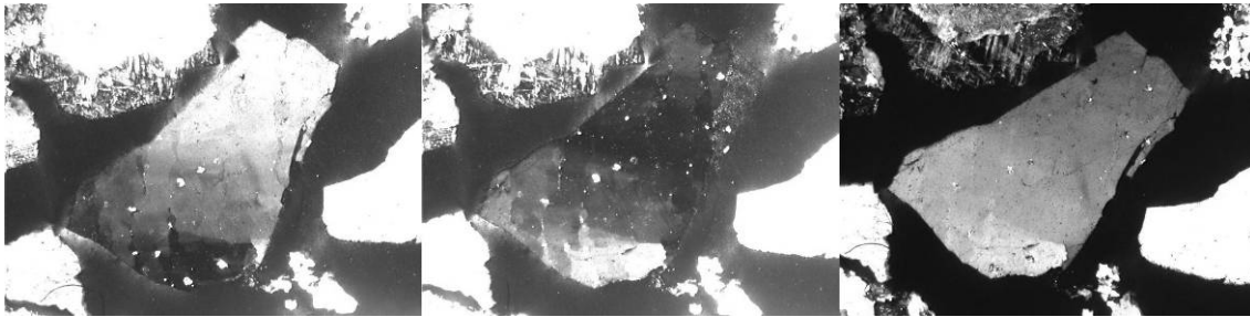
Fotografía 1. Medida del ángulo de extinción ondulante.
