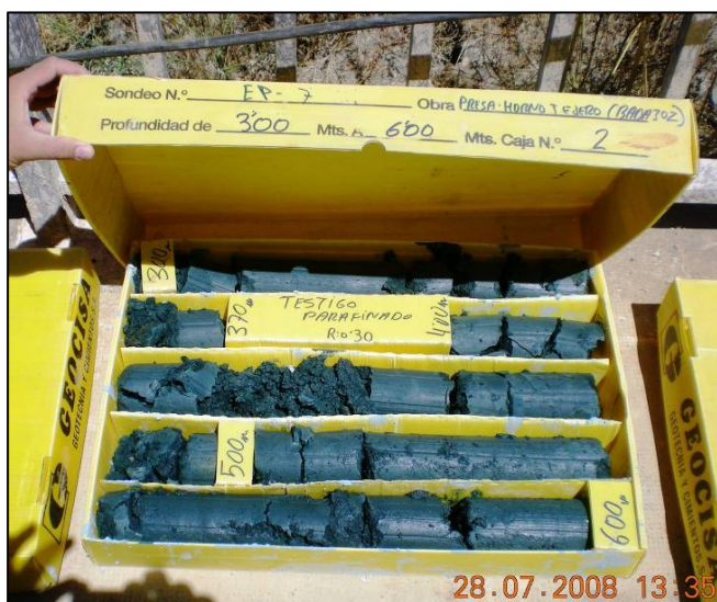
Foto: Testigo de sondeo en pantalla plástica.
