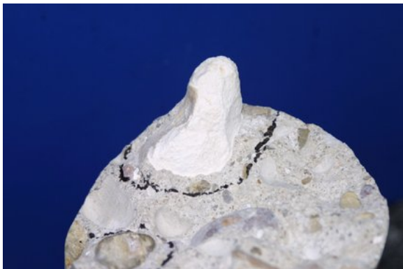
Fig.5: Halo gelatinoso alrededor de árido
