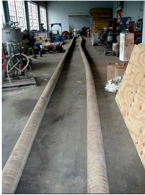
Figura 2. Aspecto de las juntas estancas infladas con aire a presión
