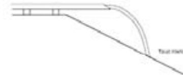
Fig. 19. Vertido mediante tubería en altura sobre el talud
