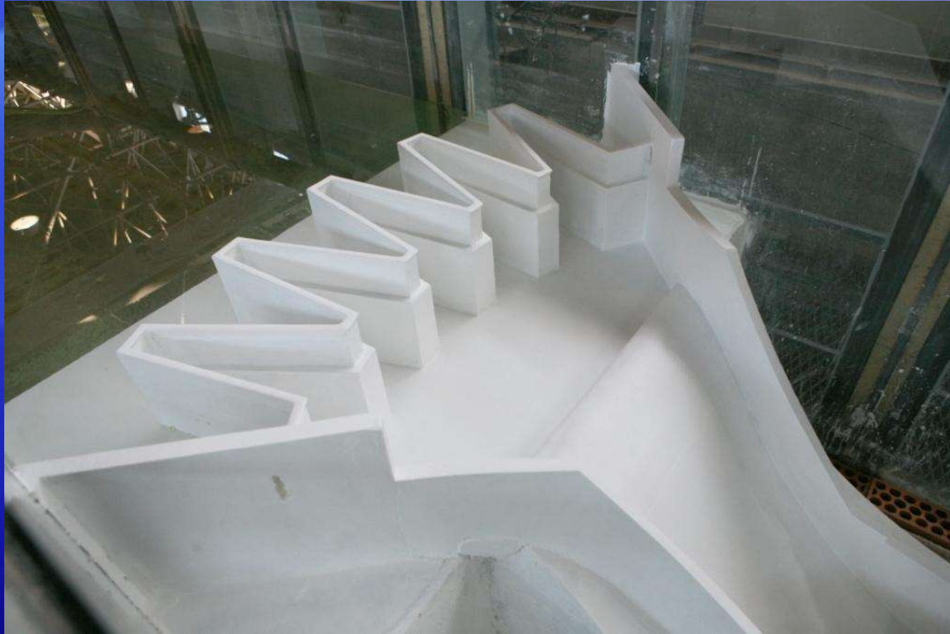
Ensayo del aliviadero de Calanda Centro de Estudios Hidrográficos del CEDEX
