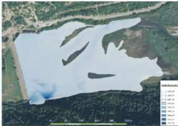
Lámina agua Inicio Fase 1 (1.049,15 m.s.n.m.)
