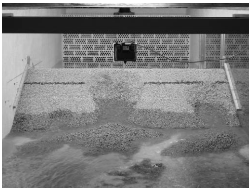
Foto N°3 Rotura por arrastre de partículas Talud 2,5
