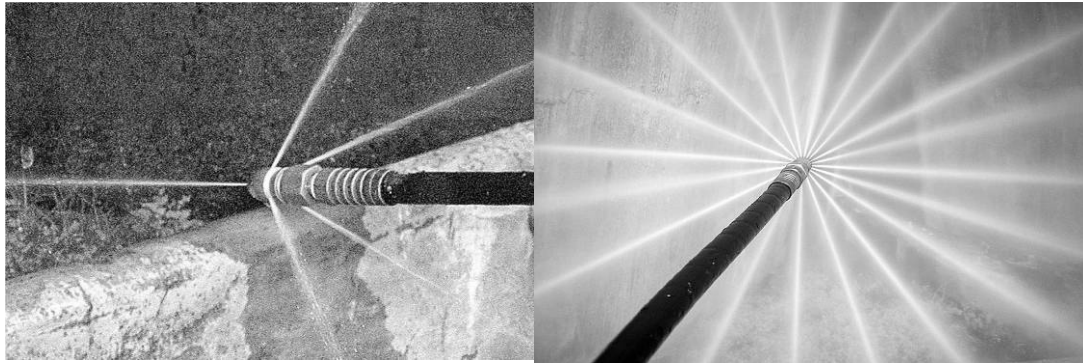
Fig. 5. (Izquierda).Tobera de chorro frontal o rompedora. Los chorros laterales sirven para ayudar en el avance.
