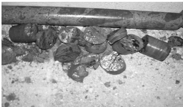
Fig. 5: Testigo obtenido durante la ejecución de los taladros
