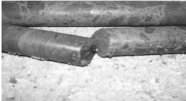
Fig. 4: Contacto hormigón- roca
